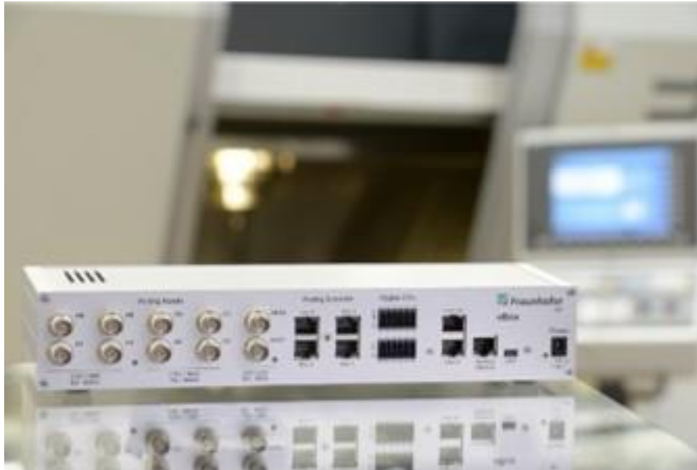
Abbildung 3: vBox, Fraunhofer IPT, Hardware zur deterministischen Datengenerierung
